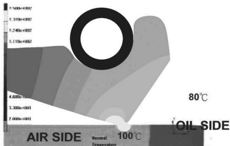
一般油封唇部温升高于操作温度20°C以上
